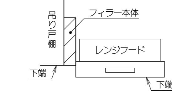
図①の位置に吊り戸棚の奥行に合わせて、仮止め用の座付ねじ①を吊り戸棚面から5mm程度まで締め付けてください。
