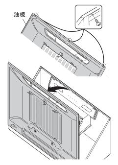
3) 参考附带的模式图纸, 将垫圈木螺丝 (5.1×45) 拧入安装墙面, 用于安装支架的左右锁孔。
