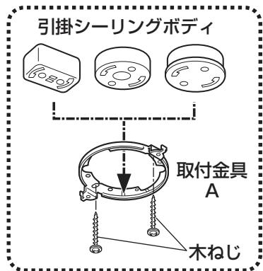
引掛シーリングボディの場合は付属の取付金具Aを引掛シーリングボディに合わせ、付属の木ねじで天井に固定してください。
