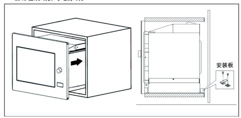
5. 打开微波炉门,用螺钉将微波炉固定在安装孔处的厨柜上。 然后将装饰套件塑料盖固定到安装孔上。
