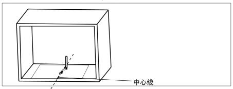
3. 拆下底柜模板,用螺丝固定安装板。
